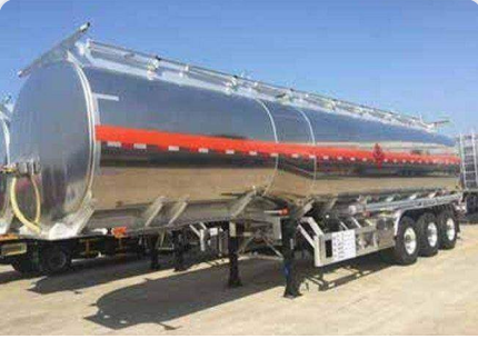
تانك ألومنيوم (صهريج محروقات) Aluminium Tanker
