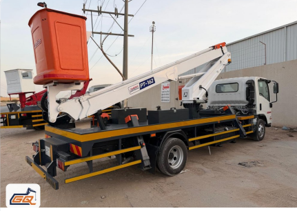
منصة أعمال هوائية تلسكوبية Telescopic Aerial Work Platform
