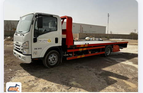
سطحة إنقاذ فُل داون (Full) (Down) Full-Down Recovery / Tow Truck
