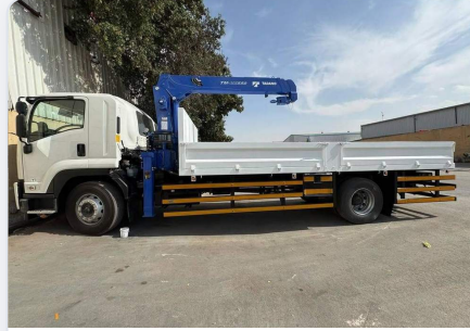
كرين تلسكوبي على شاحنة Telescopic Truck Crane (stiff-boom crane)
