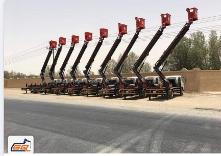
منصة أعمال هوائية 20 متر 20 m Aerial Work Platform
