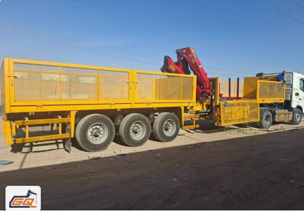
نصف مقطورة (تريلا) بكرين Flatbed Semi-Trailer with Crane
