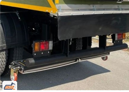
مكنسة مدارج المطارات ببار مغناطيسي
